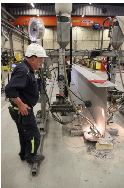
PSC Nordics svetsanläggning för stora konstruktioner i rostfritt stål.
