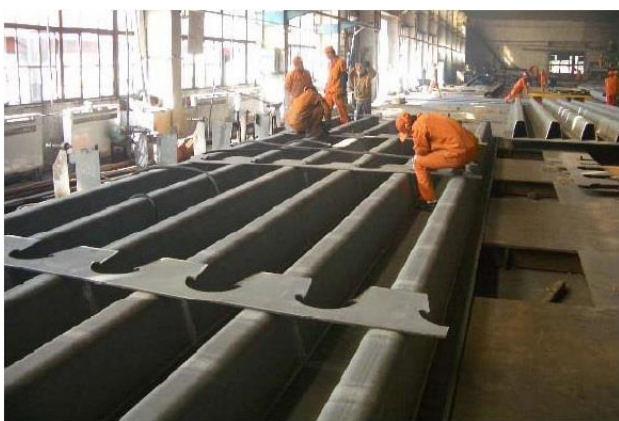
Manuell tillverkning av konventionell ortotrop platta, bild: [1].
